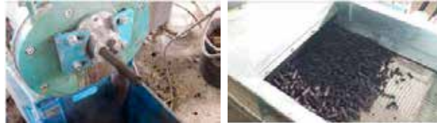
Pelletierung 3 x 20 mm Durchmesser, Fa. Lehmann
