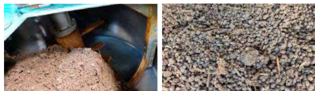
Agglomeration 94 % ≤ 10 mm Durchmesser, Fa. Eirich
